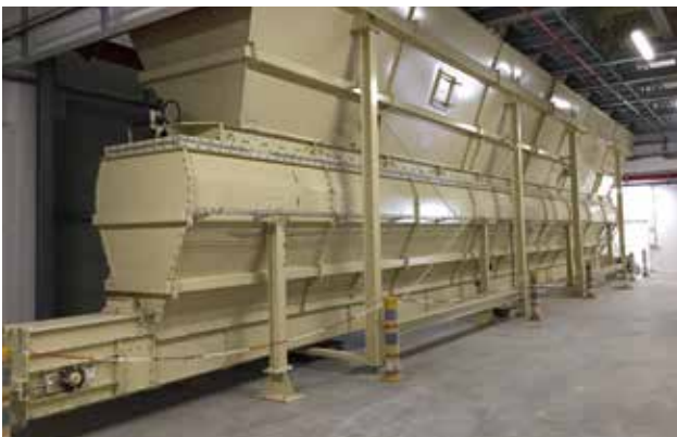
Chargenwaage mit Trichter | Batch scale with hopper
