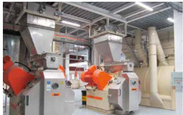
Pelletpressen 2 x 20 t/h | Pelleting press 2 x 20 t/h
