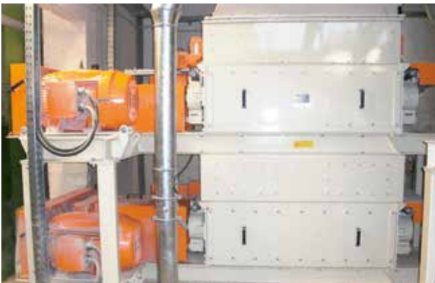
Doppelwalzenstühle 2 x 35 t/h | Double roller mills 2 x 35 t/h
